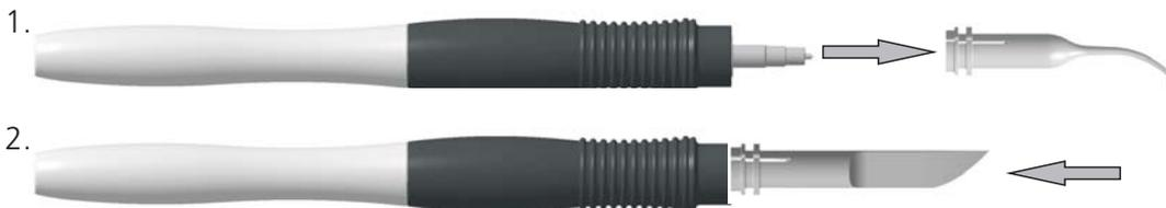
1. Avec une pince appropriée, retirez la sonde de modelage de la spatule chauffante électronique dans le sens de la flèche
