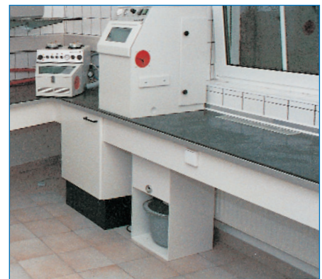
Récupérateur de sable S1
