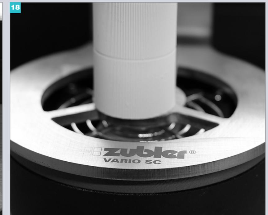
Photos 17 et 18 : Positionnement du cylindre sur le Vario SC qui permet de refroidir tout en maintenant le piston en pression
