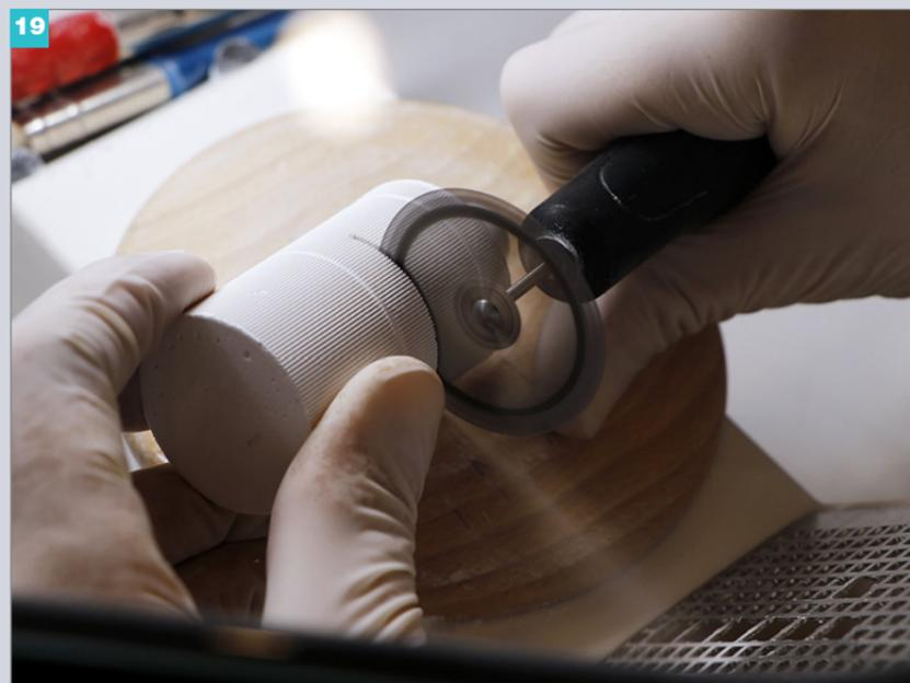
Photos 19 et 20 : Élimination du revêtement à l'aide d'un disque diamanté puis sablage
